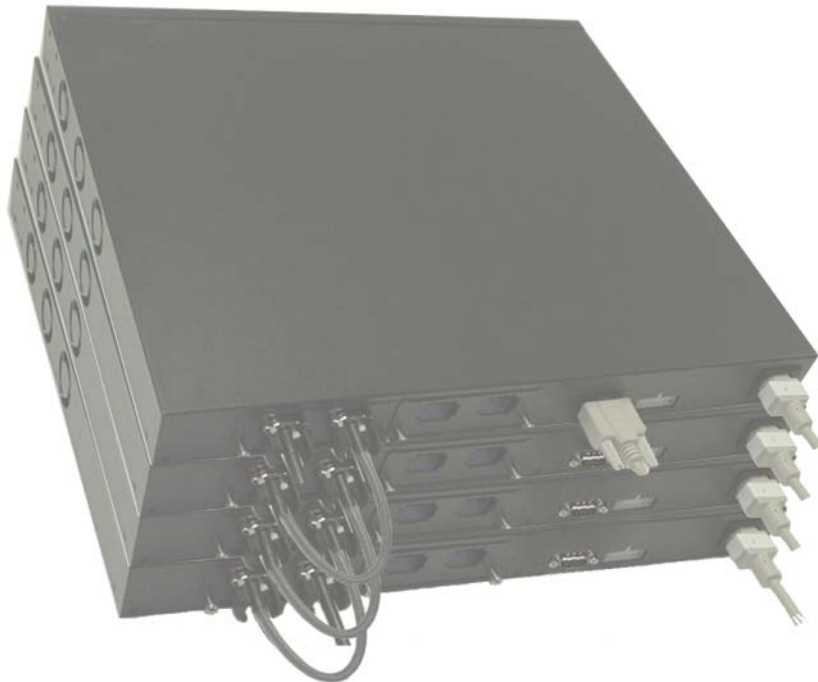
Figure 1-3. Connexion d'une pile de commutateurs
